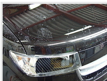
① ボディを洗車し水滴は残ったまま。 もしくはシャワー水で施工箇所を 濡らしながら作業します。
